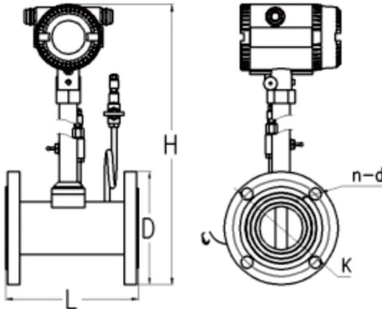
图 6-3 温压补偿法兰连接型示意图
