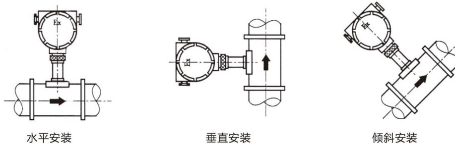
图 7-1 安装方式示意图
