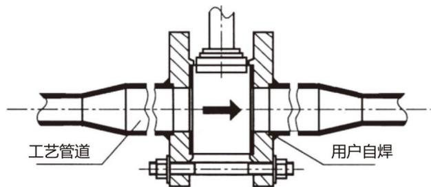
图 5 扩径管式安装
