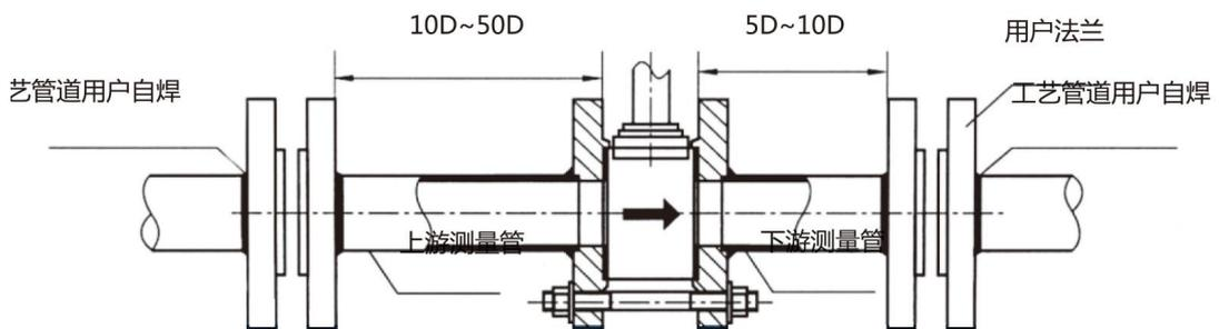
图 3 I 型测量管式安装
