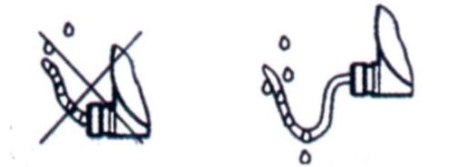
图7-3 防水接线示意图
