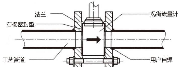
图 1 夹装法兰式安装
