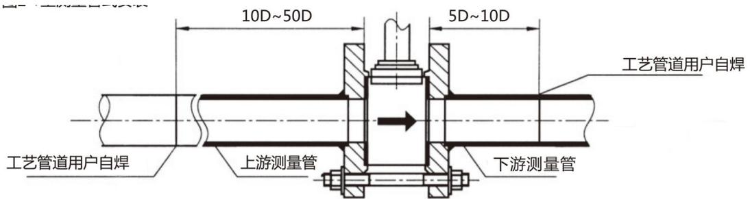
图 2 型测量管式安装
