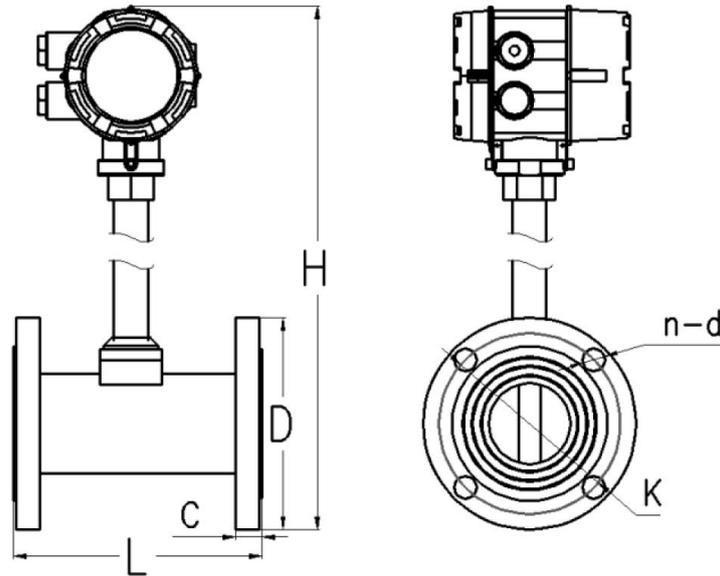
图 6-1 普通法兰连接型示意图
