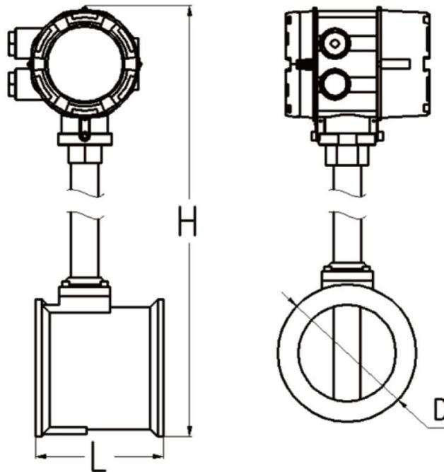
图 6-2 普通夹装连接型示意图
