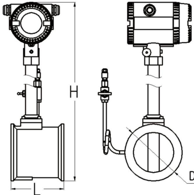
图 6-4 温压补偿夹装连接型示意图
