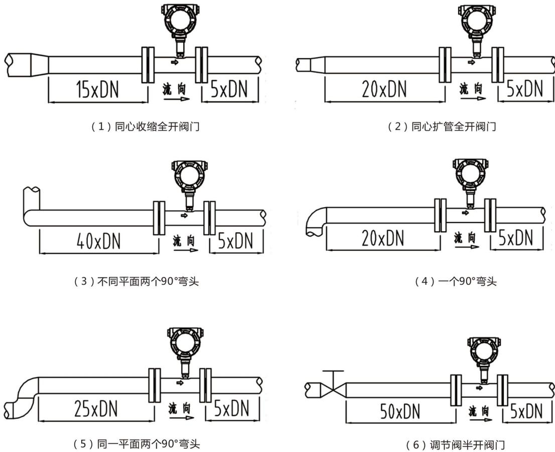
图 7-4 所需上下游直管段长度
